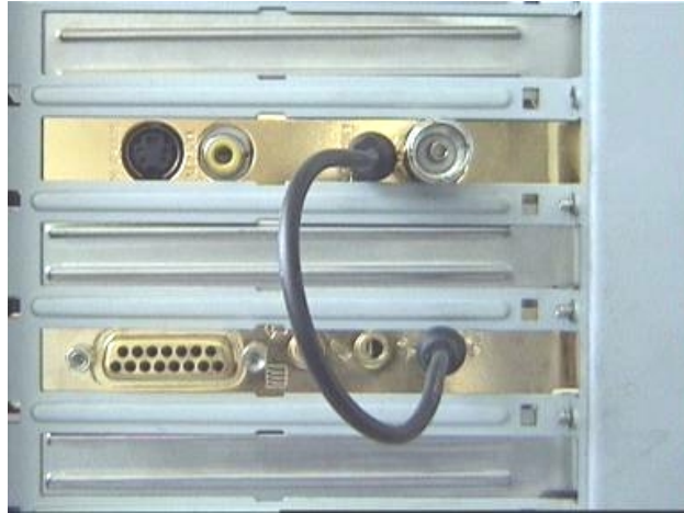
fig. 1: Conecte la salida de la tarjeta de TV con la entrada de la tarjeta de sonido, como se muestra en la ilustración.
