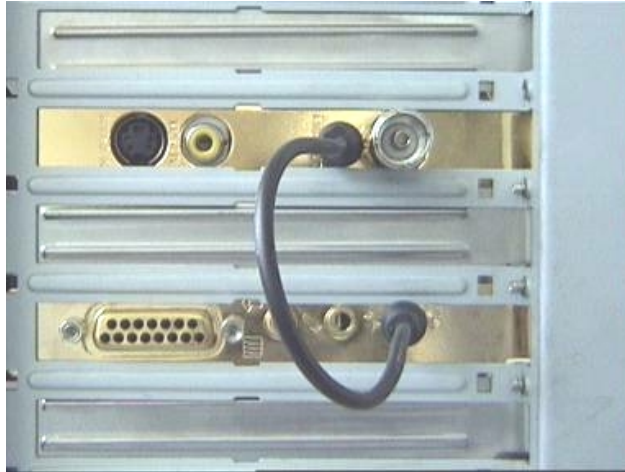
Abb. 1: Verbinden Sie den Ausgang der TV-Karte mit dem Eingang der Soundkarte, wie in dieser Abbildung zu sehen.
