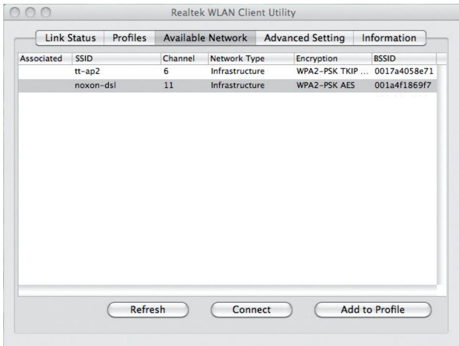
In der Eingabemaske „Profile Properties“ müssen Sie - sofern es sich um ein verschlüsseltes Netzwerk handelt - den entsprechenden WLAN-Key eingeben. Mit einem Klick auf OK speichern und beenden Sie die Einrichtung des NOXON WLAN Stick.
